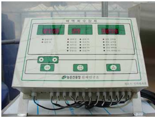
그림 24 배액 회수 및 희석장치(농진청, 2004)
